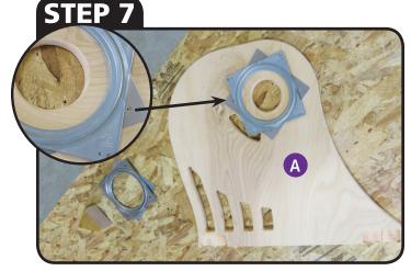
ON THE INSIDE OF BOTH OUTER PANEL A & B ALIGN ROLLER BEARINGS ON PREDRILLED HOLES
